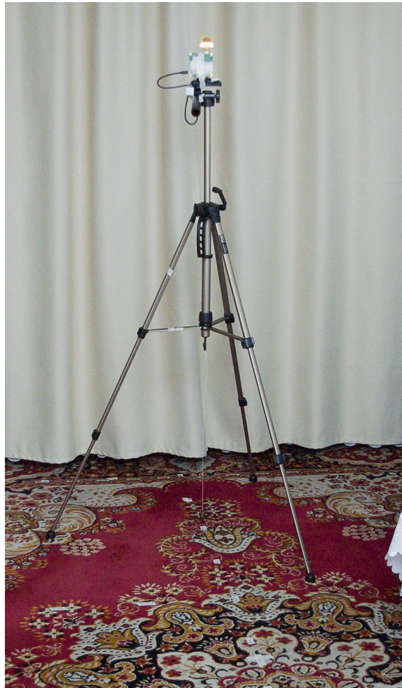
Ilustr. 4.4: Statyw ze znacznikiem podczas pomiarów statycznych
